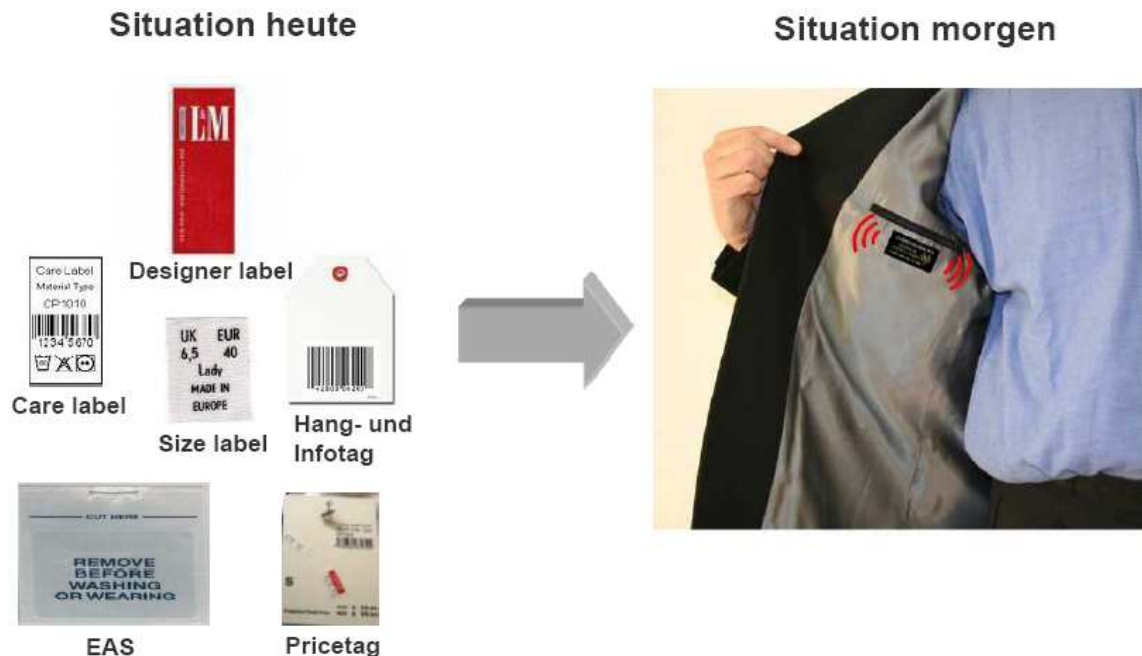
Abb. 10: Unsichtbare Integration von RFID
